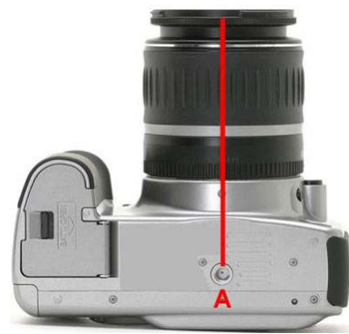
Appareil photo avec écrou de pied aligné avec l'axe optique de l'objectif
